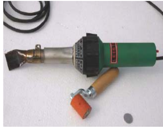
Fig. 24. Soldador de plástico muy útil para recubrir los cajones
