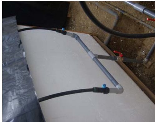
Fig. 29. Tubos alimentadores para cajones anchos
