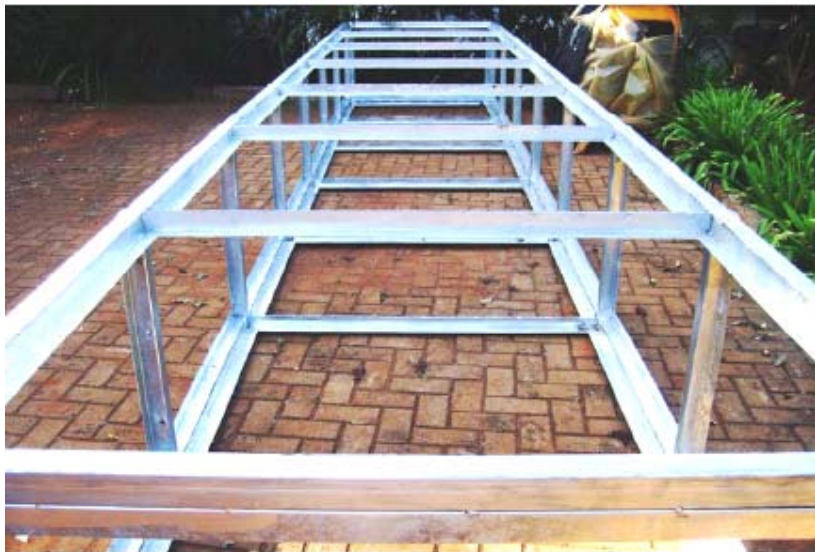
Fig. 19. Estructura metálica de un cajón aeropónico. GTIL. Nairobi-Kenya
